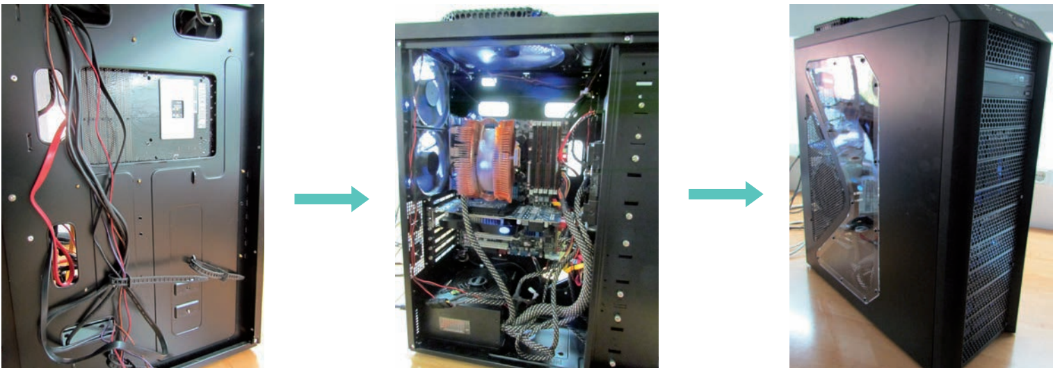
Fig. 6.39. Ordenamos los cables mediante bridas o fijaciones, comprobamos que todo está correctamente montado y cerramos la caja para finalizar el montaje.
