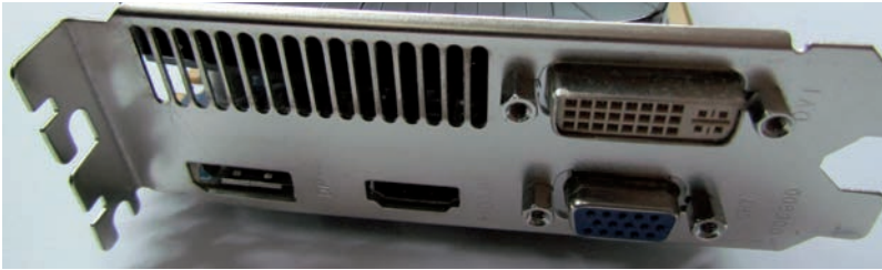
Fig. 6.38. Conexiones tarjeta gráfica, que ocupa dos salidas.
