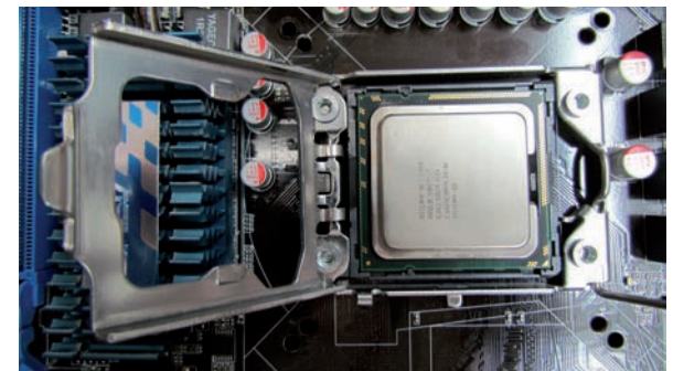
Fig. 6.13. Microprocesador encajado correctamente en su socket.
