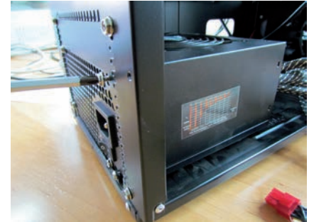
Fig. 6.22. Atornillamos la fuente de alimentación al chasis.
