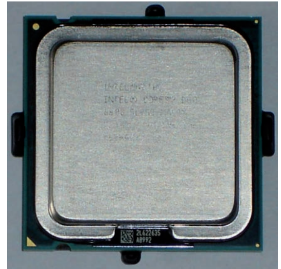
Fig. 3.27. Procesador de socket (véase Socket LGA 775 en placa base en la Figura 3.7).
