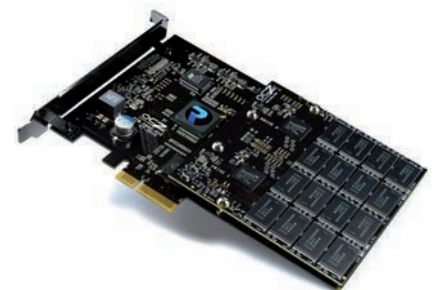
Fig. 4.13. Unidad SSD con conexión PCI Express.
