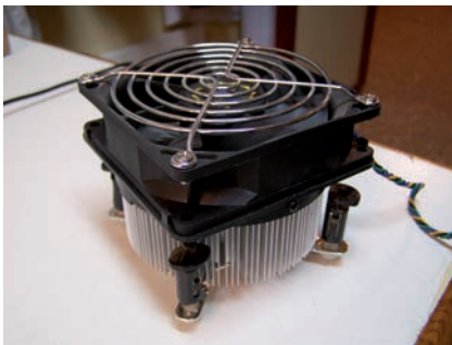
Fig. 3.31. Disipador con su ventilador.
