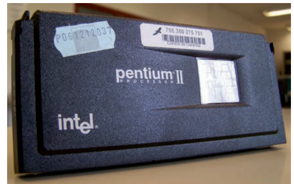
Fig. 3.28. Procesador para slot (véase Slot para Pentium II en placa base en la Figura 3.8).
