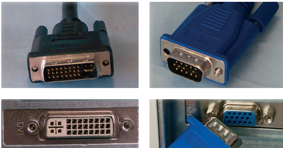
Fig. 9.9. Conectores del monitor: DB15F y DVI.
