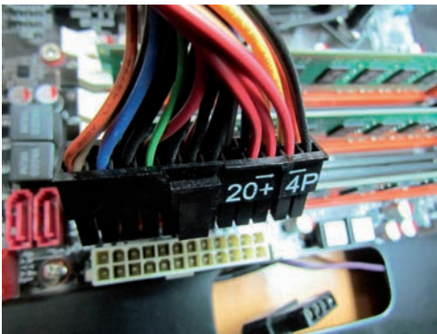
Fig. 6.24. Conectores de la fuente de alimentación colocados en la placa base.
