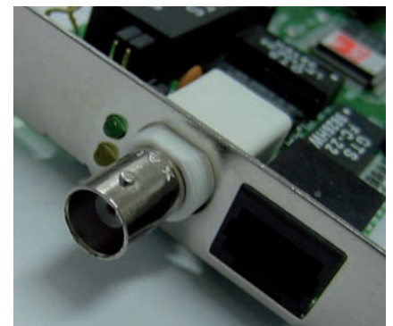
Fig. 5.13. Tarjeta de red con conectores BNC y RJ45.
