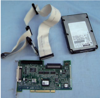
Fig. 4.11. Tarjeta adaptadora SCSI, cable SCSI y disco duro SCSI.
